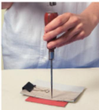
2 Pour percer des trous plus larges utilisez une aïline. Placez le bloc à percer sur un support de protection. Placez l'aïline à la verticale, perpendiculaire au bloc, puis frappez-la doucement avec un marteau. Si vous effectuez la reliure au raphia, à la corde ou au lacet de cuir, utilisez une aïline épaisse et pour une couture au ruban ou au fil classique, une aïline fine.
